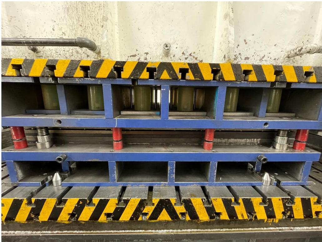
Imagen 52. Montaje de troquel 178033 op. 10-30 con centradores.
