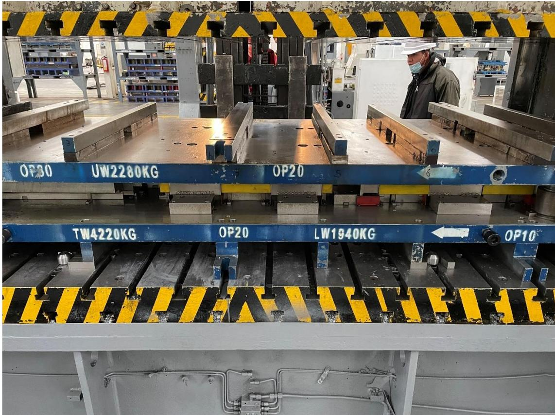
Imagen 53. Montaje de troquel 178181 op. 10-30 con centradores.
